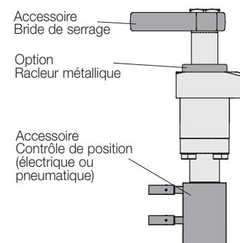
Le contrôle de position est commandé par une «tige traversante». Cette tige est en saillie au fond du vérin de serrage pivotant et possède une étanchéité hydraulique.
