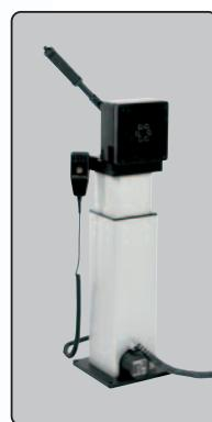
Lors de l'assemblage en  quipe les employ s r glent individuellement la hauteur d'assemblage souhait e par l'interrupteur   main du module de levage   lectrique.
